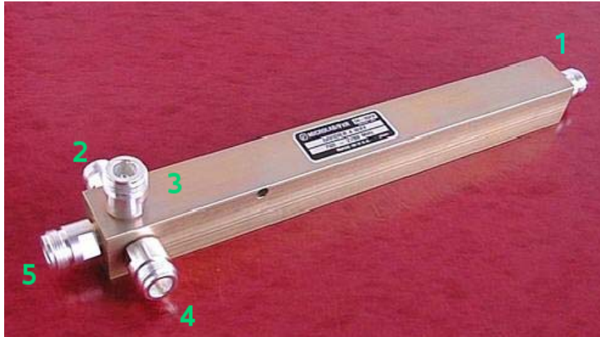
Abbildung 6.3: Breitbandiger Microlab/FXR 4-Fach Splitter, der ein Aufteilen der Verstärkerleistung in vier leistungs- und phasengleiche Signale ermöglichen soll.
