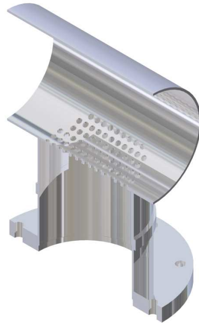
(b) Schnitt durch das neue T-Stück, zu erkennen sind die einzelnen Bohrungen zur Reduktion der Wakefelder
