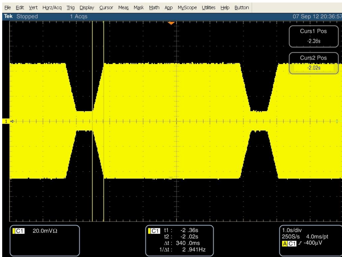
Abbildung 4.2.7: Signal des DAC-Ausgangs des LLRF-Systems während des Rampbetriebs des Boostermodus an ELSA. Die Enveloppe des Signals zeigt die Amplitude der HF-Ansteuerung des DAC aufgenommen mit einem Oszilloskop.
