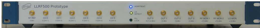
Abbildung 4.2.1: Prototyp des DIMTEL LLRF-Systems, welches in dieser Studie an ELSA zum Einsatz kam [Tey11].
