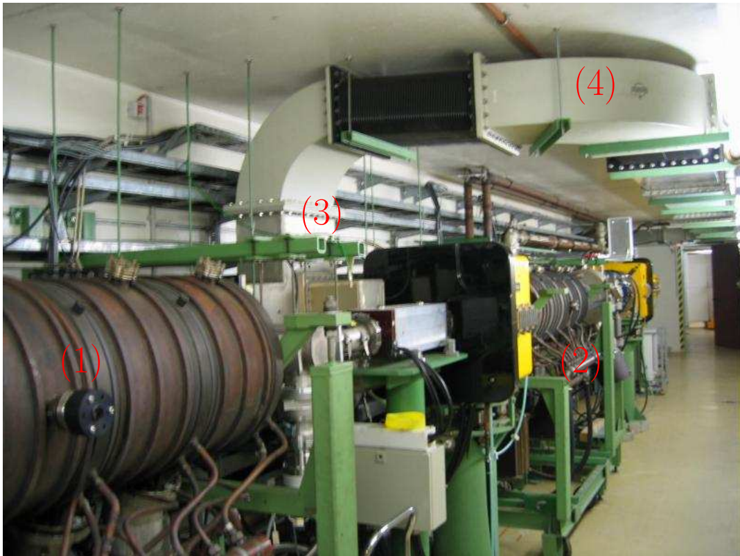
Abbildung 3.2.1: PETRA-Cavity 1 (1) und 2 (2) im ELSA Stretcherring mit dem Magischen T (3) sowie dem Hohlleitersystem (4).
