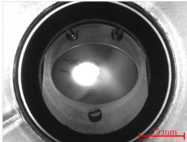
Abbildung 4.3: Aufnahme des Chromoxschirmes bei getriggertem Kathodenstrahl.
