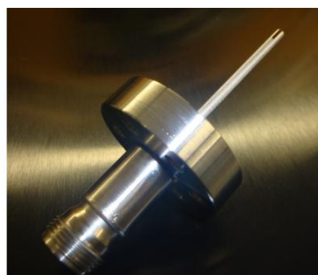
(f) Modifizierte 50 \Omega -Hochfrequenz-Durchführung der Firma Hositrad . Der geschlitzte Innenleiter sorgt für einen guten elektrischen Kontakt in dem für den Leiter vorgesehenen Loch im Steg.
