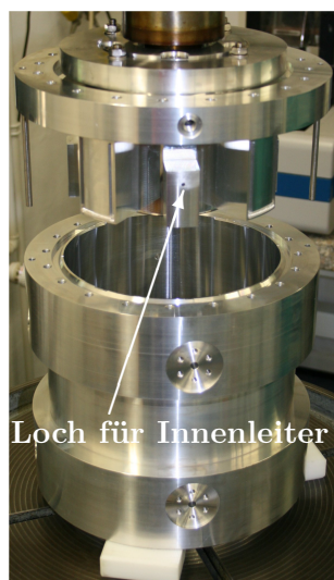
(a) Mantel und Innenteil des Kicker-Cavitys auf der Montagevorrichtung. Am Mantel sind die Löcher für die Hochfrequenz-Durchführungen zu erkennen; am Innenteil der Steg mit dem Loch für den Innenleiter der Durchführungen.
