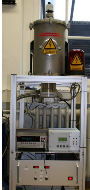
Abbildung 6.8: Messaufbau zum Test der Hochspannungsfestigkeit.
