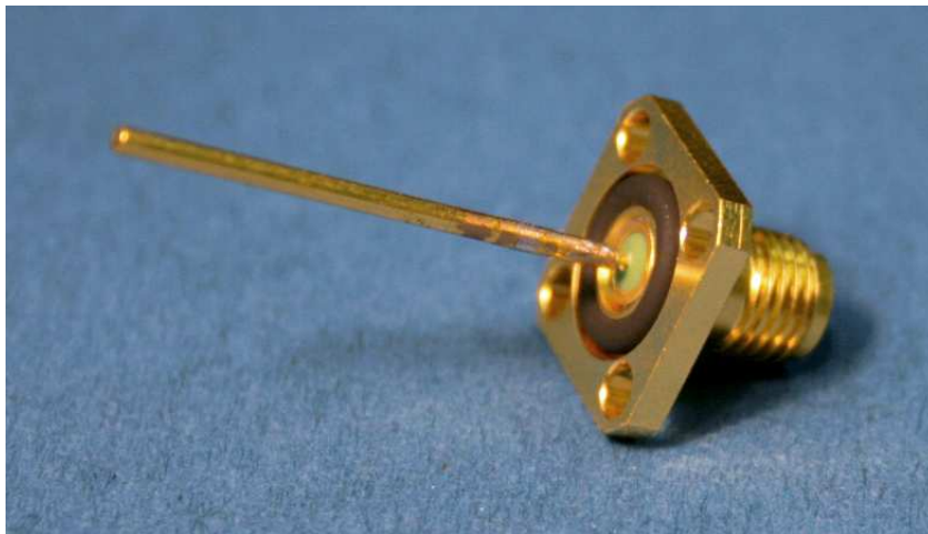
Abbildung 3.3: 25 mm lange, vergoldete Koppelnadel welche durch Lötten an einer vakuumdichten SMA-Durchführung befestigt wurde [Pus12].
