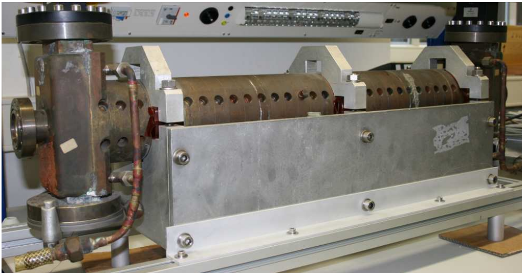
Abbildung 3.5: Foto der Beschleunigungsstruktur für das EKS.
