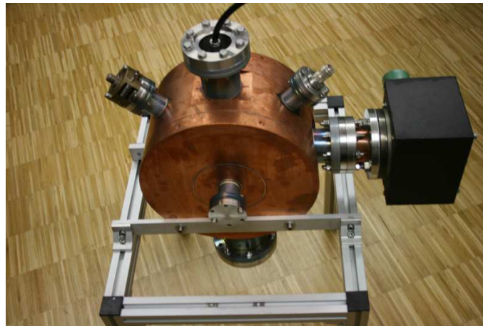
Abbildung 2.10: Foto des Kupferresonators: Vorne ist der Flansch für das Strahlrohr, rechts der Motor des Abstimmstempels und oben in der Mitte die Zuleitung zur Koppelschleife zu erkennen.
