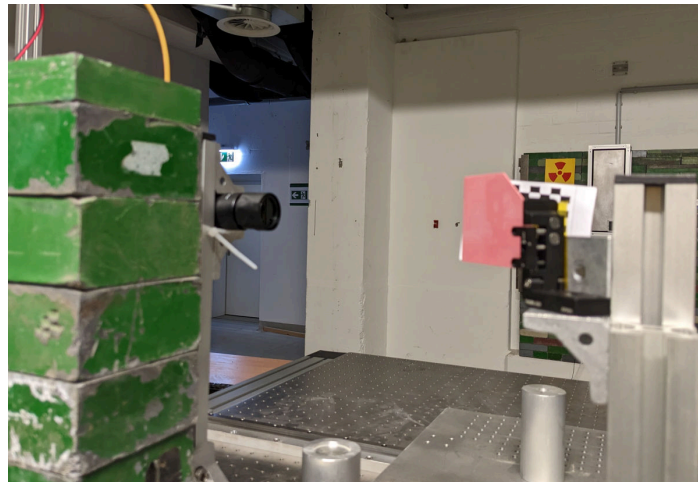
Abbildung 2.6: Aufbau des Chromox-Schirms, bestehend aus einem fluoreszierenden Chromox Schirm (in pink) in Verbindung mit einer Kamera zur Erfassung der Fluoreszenz.
